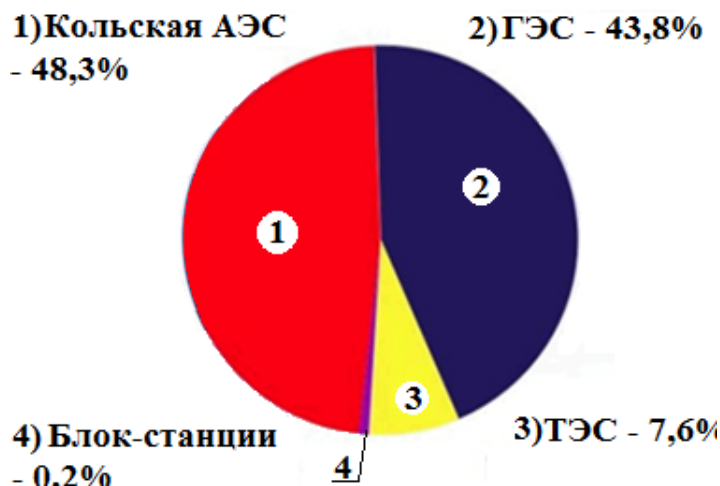
Рис. 1. Распределение установленных мощностей электростанций Мурманской обл. по типам электростанций:
