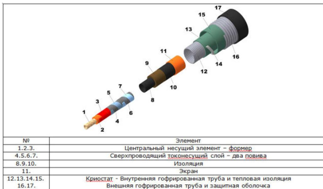
Рис.7. Эскиз конструкции ВТСПК 20 кВ (Россия)
