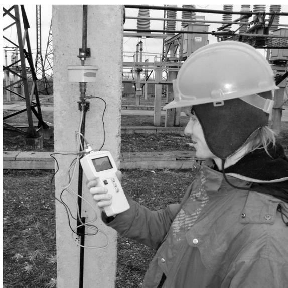
*Рис.1. Считывание информации, хранящейся в памяти регистратора срабатываний ОПН, с помощью прибора «СКАТ-4»*
