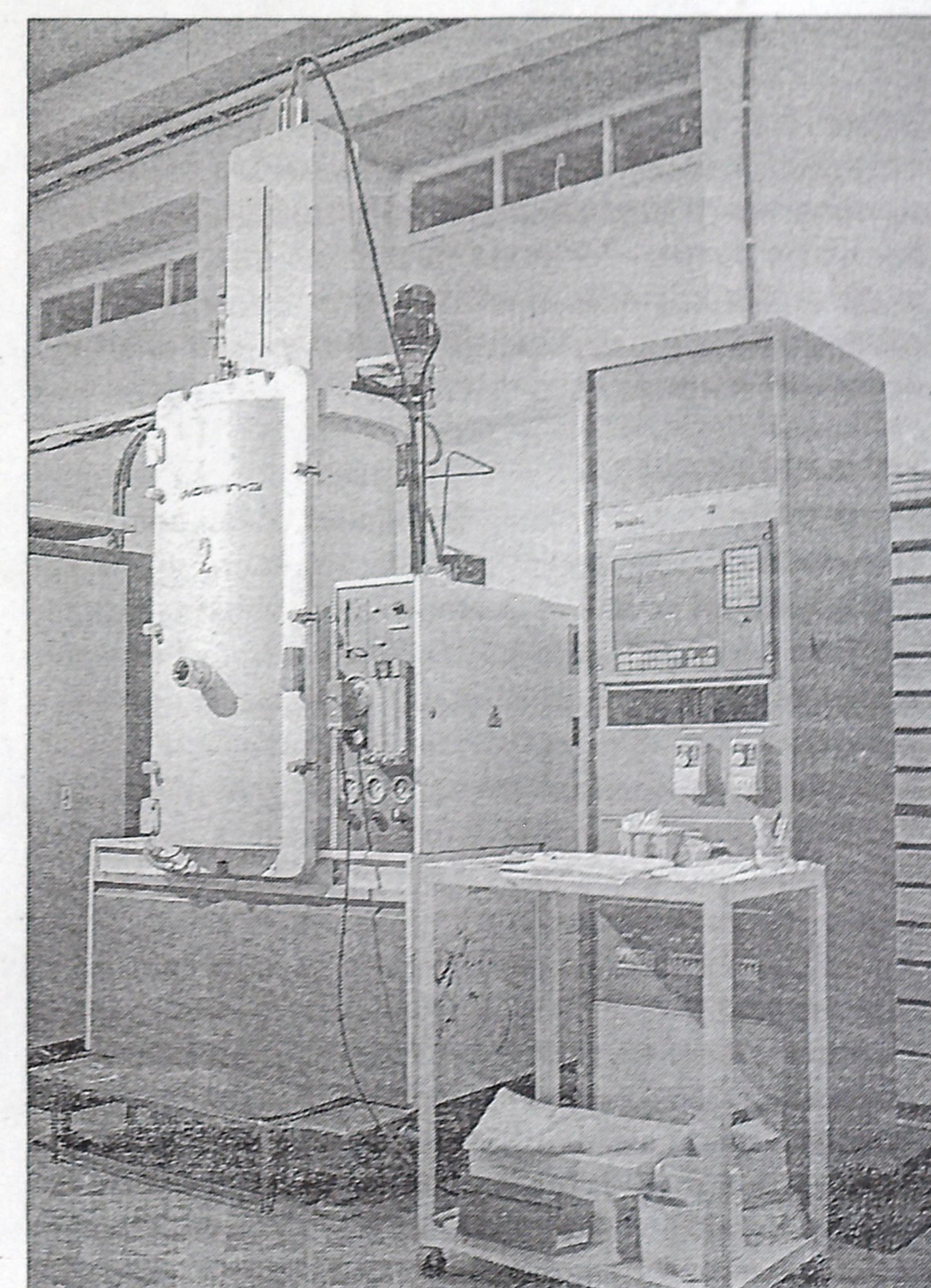
Установка «Кристалл-2» для выращивания монокристаллов методом Чохральского
