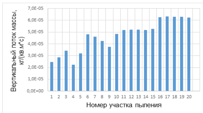
Рис. 3.38. Вертикальный поток массы на участках пыления при скорости ветра 11 м/с, кг/(м 2 ·с)
