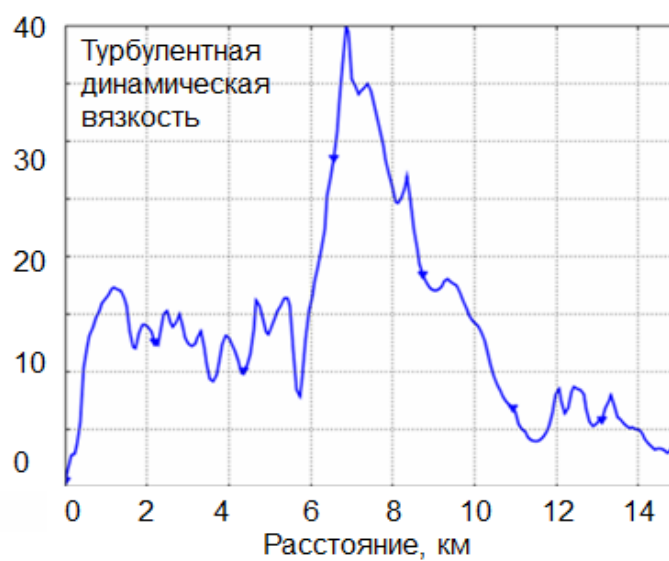
Рис. 3.18. Распределение коэффициента турбулентной динамической вязкости ( \text{Па}\cdot\text{с} ) в центральном вертикальном сечении модели (+1 м над пылящей поверхностью) для района модели «хвостохранилище АНОФ-2 — г. Апатиты» (высота пляжа хвостохранилища 200 м)
