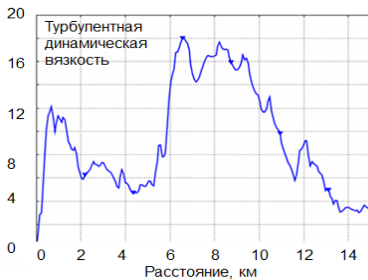
Рис. 3.16. Распределение коэффициента турбулентной динамической вязкости ( \text{Па}\cdot\text{с} ) в центральном вертикальном сечении модели (+1 м над пылящей поверхностью) для района модели «хвостохранилище АНОФ-2 — г. Апатиты» (высота пляжа хвостохранилища 180 м)
