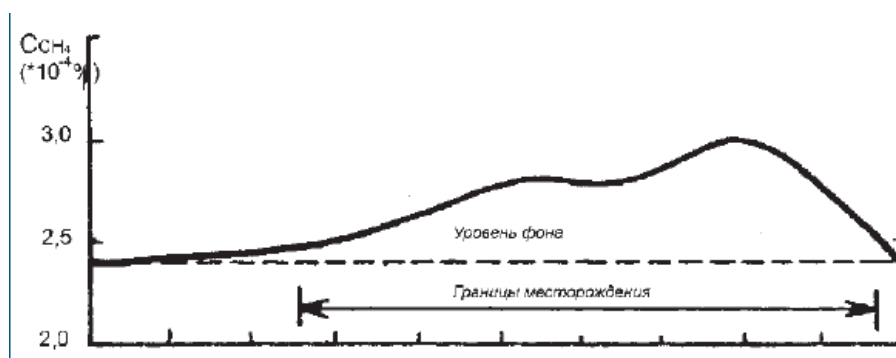
Рис. 4. Изменение концентрации метана по профилю, пересекающему Анастасиевско-Троицкое газовое месторождение
