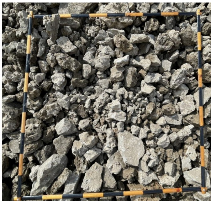
Рисунок 1 – Взорванная масса на поверхности конуса
