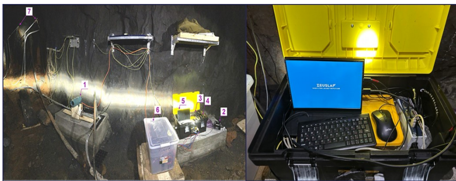
Рисунок 1 – Общий вид подземного пункта (слева) и системы регистрации (справа) (1 – расходомер EM470; 2 – акселерометр RefTek 147-01/3; 3 – аналогово-цифровой преобразователь L-Card E14-140M; 4 – промышленный компьютер ICO300E; 5 – портативный монитор; 6 – АКБ; 7 – субгоризонтальные скважины)
