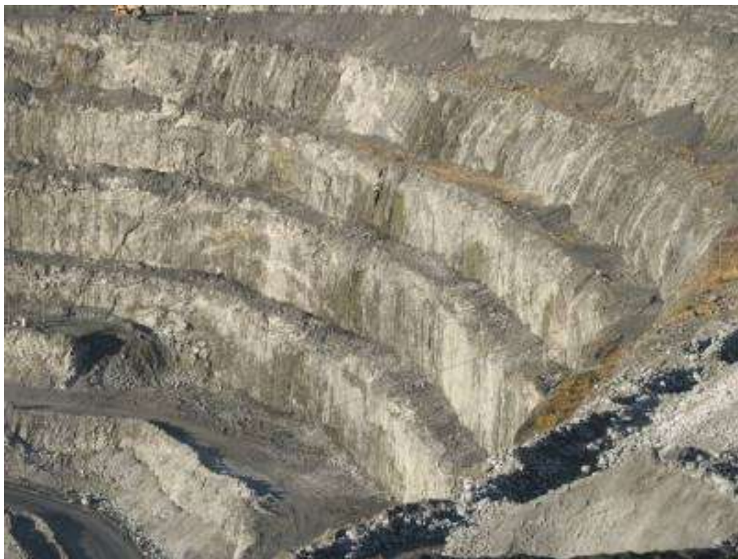
Рис. 1. Реализация конструкции борта со сдвоенными уступами и технологии «щадящего взрывания» на карьере рудника «Железный» Ковдорского ГОКа
