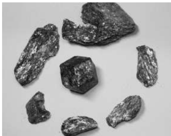
Рис. 3. Продукт электроимпульсного дробления гранатсодержащих пород Кейвского месторождения
