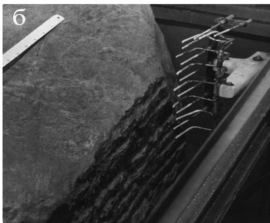
Рис. 17. Схема пассировки блоков природного камня. Рисунок установки (а), инструмент и блок нестандартного валуна в процессе пассировки (б) и после пассировки в распиловочном станке (в)
