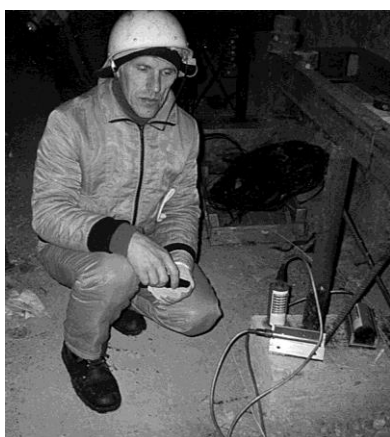
Рис. 9. Установка цифровой сейсмостанции (на фото – С.И. Петров) и схема размещения датчиков микрогруппы «Амдерма» в шахтных выработках (3-С – трехкомпонентная станция, Z – датчики вертикальной компоненты)
