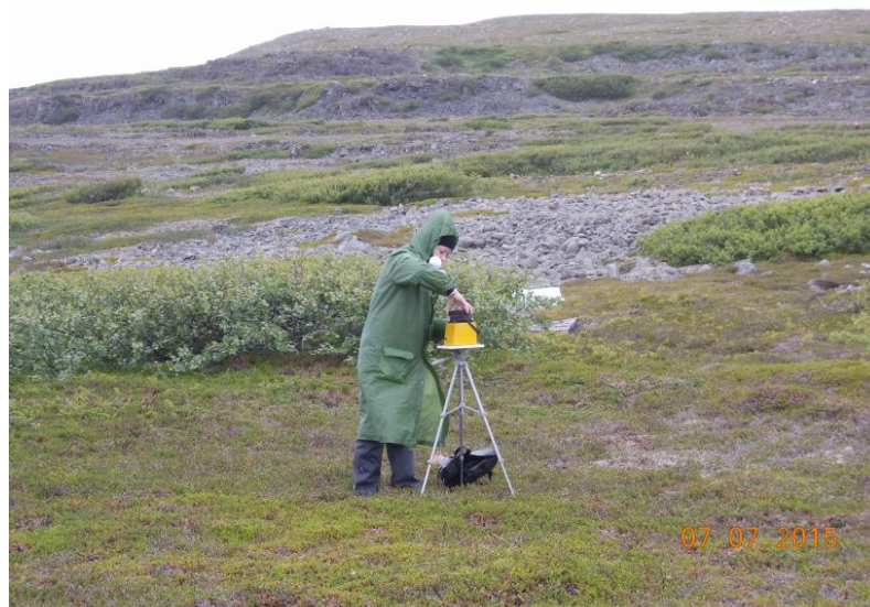
Рис. 1. Отбор проб воздуха автоматическим пробоотборником ПУ1Б на п-ове Рыбачий
