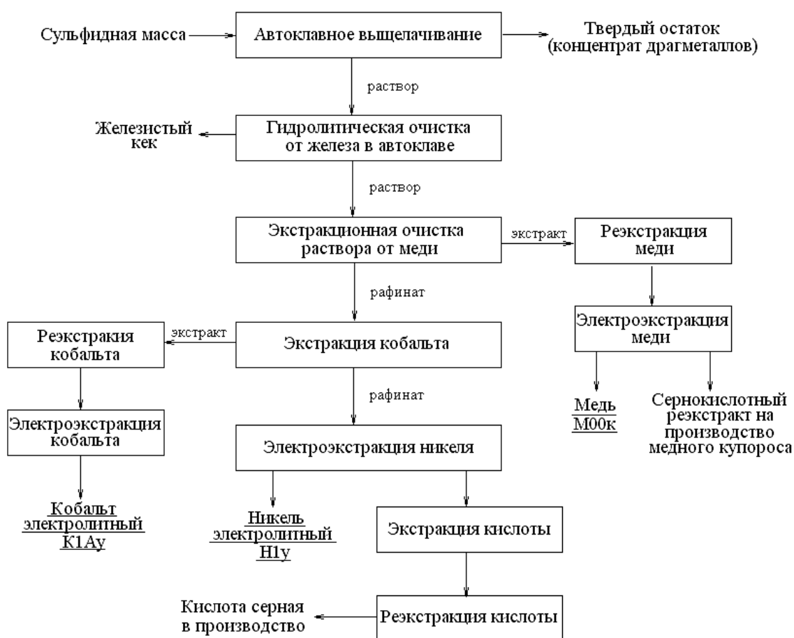
Рис. 4. Принципиальная технологическая схема переработки сульфидной никель-кобальтовой массы в условиях комбината «Южуралникель»
