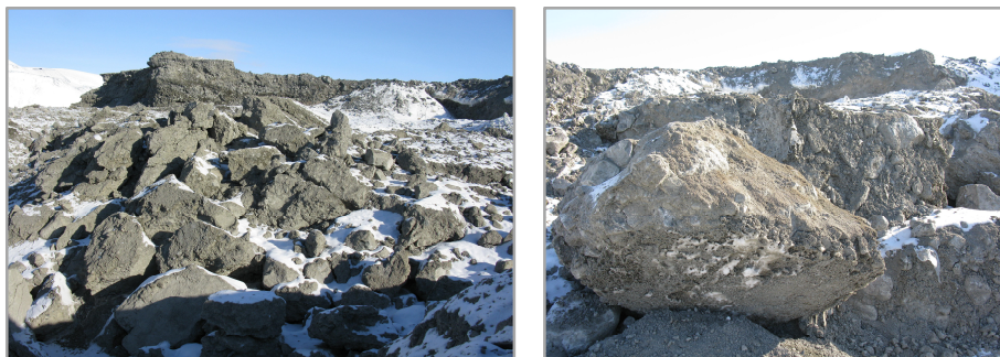
Рис. 1. Снежно-породные конгломераты-негабариты после проведения отбойки
