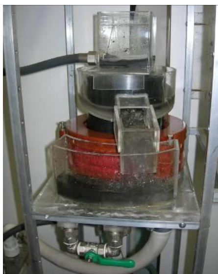
Рис. 1. Общий вид экспериментального образца магнитно-гравитационного сепаратора
