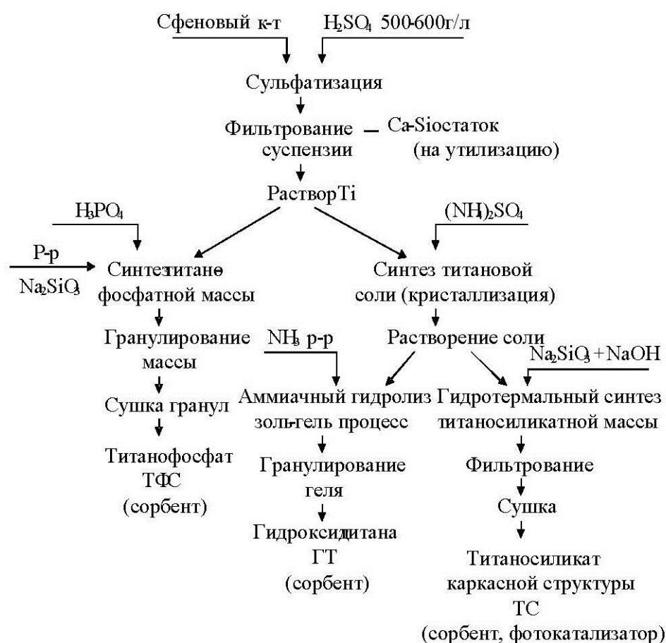
Рис. 1. Принципиальная технологическая схема сернокислотной переработки сфена с получением титаносодержащих сорбентов
