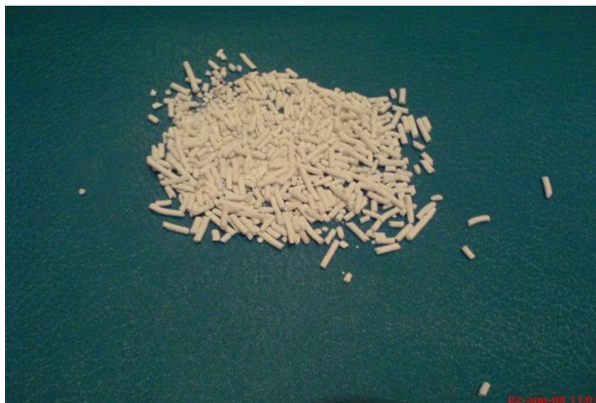
Рис. 2. Гранулы ТФС сорбента. Гранулы – 3–10 мм
