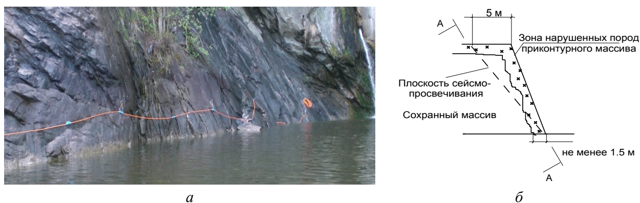
Рис. 3. Схема сеймопросвечивания откоса: а — установка датчиков; б — сечение откоса
