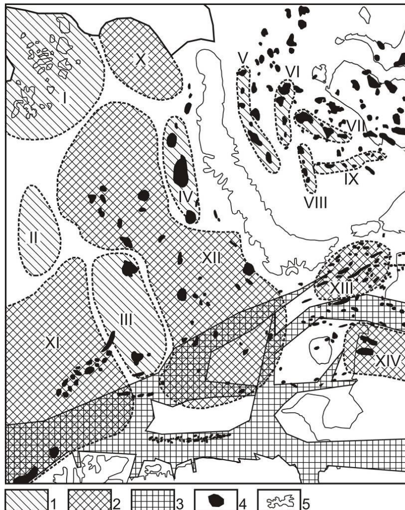
Рис. 3. Схема нефтегазоконтролирующих структур Баренцево-Карского региона: 1 – поднятия и валь: I-IV – поднятия Свальбардской плиты: I – Земли Франца-Иосифа, II – Персея, III – Центрально-Баренцевское, IV – Адмиралтейское; V-IX – мегавалы Южно-Карской плиты: V – Викуловский, VI – Кропоткинский, VII – Русановский, VIII – Воронинский, IX – Обручевский; 2 – прогибы, впадины и синеклизы: X-XIV – Свальбардская и Печорская плиты: X – Святой Анны, XI – Нордкапский, XII – Восточно-Баренцевоморская, XIII – Печорская, XIV – Ижмо-Печорская; 3 – Норвежско-Мезенская система рифтов; 4 – потенциально нефтегазоносные структуры и выявленные месторождения углеводородов; 5 – контур береговой линии
