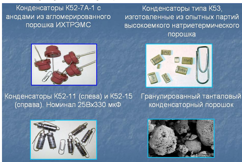
Рис.4. Конденсаторы, изготовленные с использованием полученных в ИХТРЭМС танталовых порошков, и образец самого порошка
