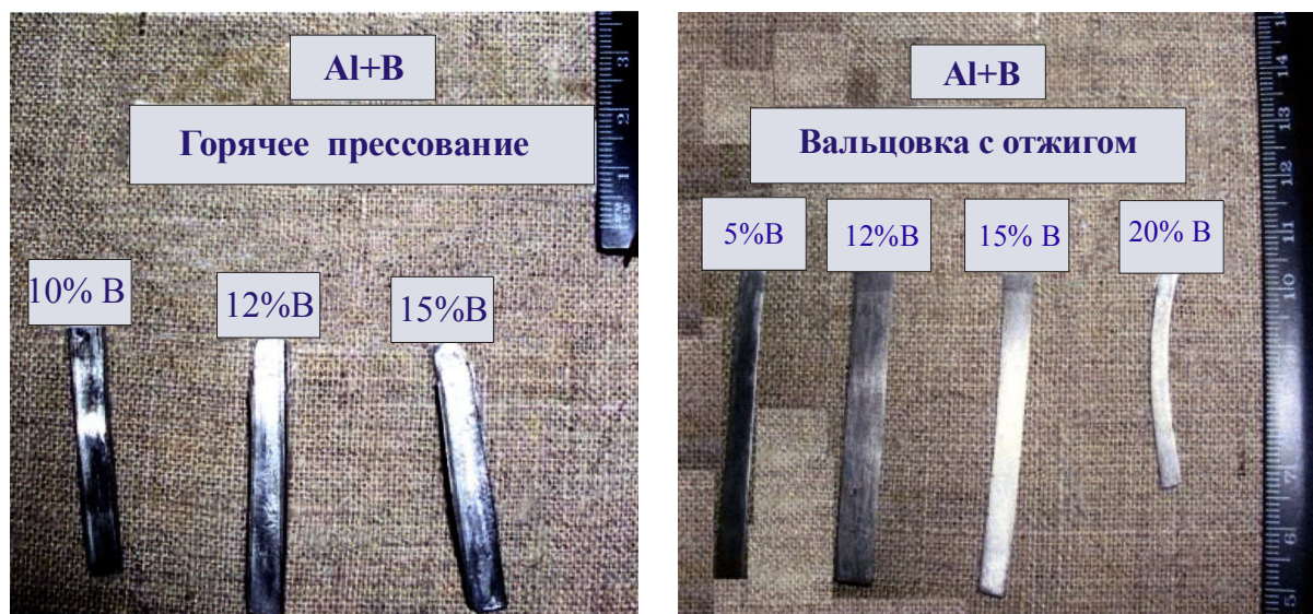
Рис. 5. Образцы изделий из композиционного материала Al-B
