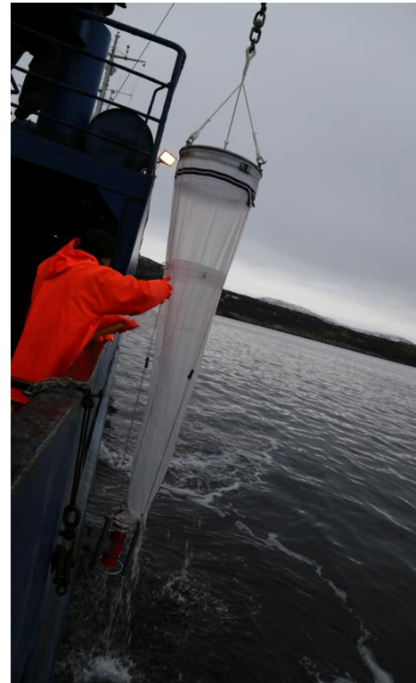
Рис. 6. Отбор проб зоопланктона в Кольском заливе с помощью сети WP2 с борта НИС “Дальние Зеленцы” (фото О. П. Калинка)
