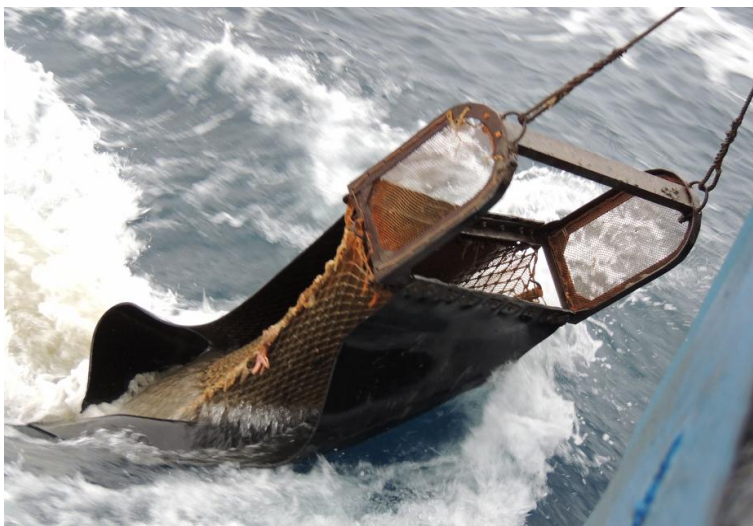
Рис. 7. Отбор проб макрозообентоса тралом Сигсби с борта НИС “Дальние Зеленцы” в июле 2017 г. в Баренцевом море (фото М. А. Павловой)
