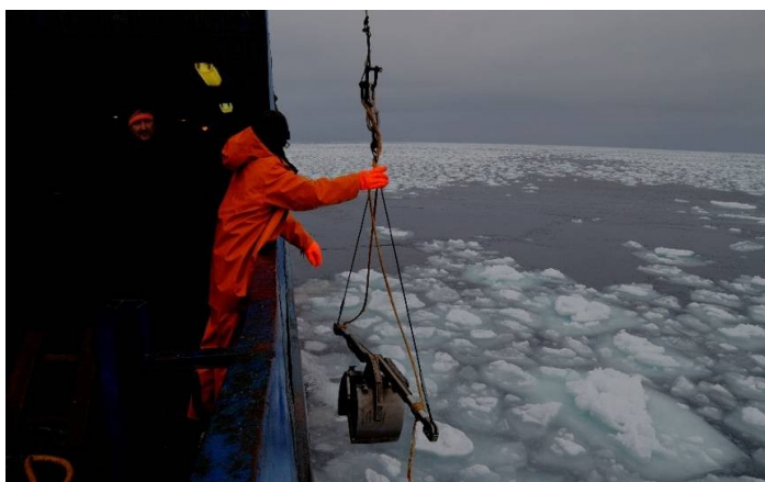
Рис. 4. Отбор проб макрозообентоса дночерпателем ван-Вина (Рейсовый ..., 2016)
