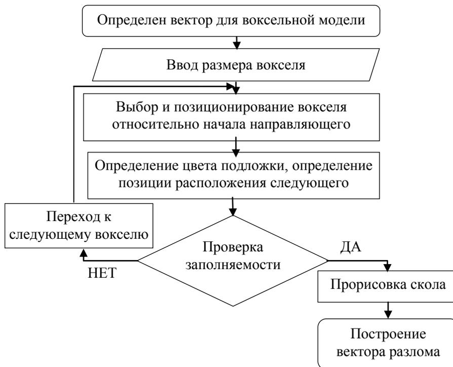
Рис. 4. Блок-схема алгоритма формирования воксельной поверхности на основе одного направляющего вектора
