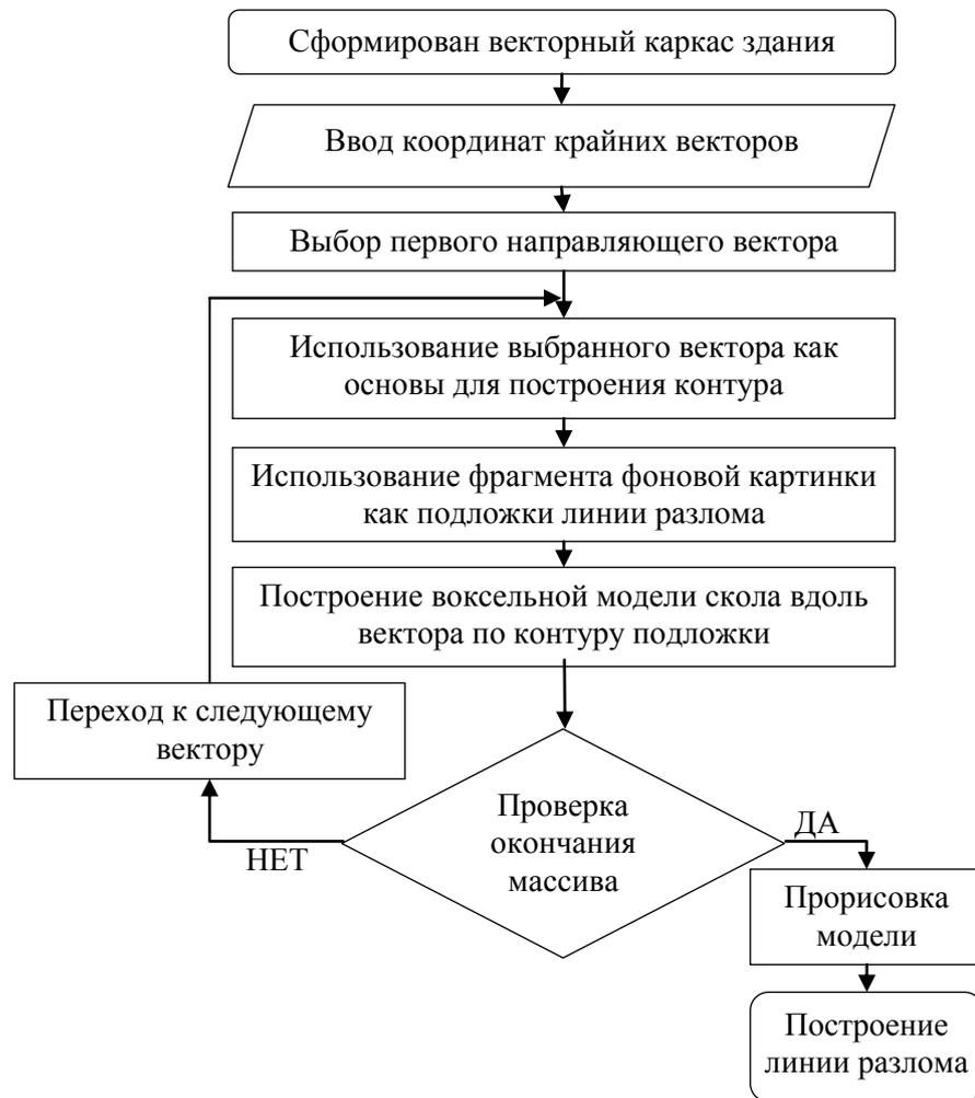
Рис. 2. Блок-схема алгоритма моделирования осколков объекта разрушения
