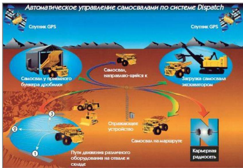
Рис. 4. Управление самосвалами в системе Dispatch
