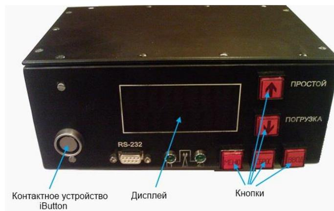
Рис. 5. Внешний вид работомера
