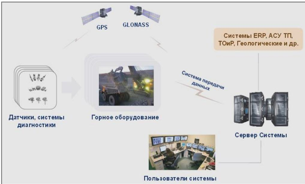
Рис. 2. Схема построения системы «Карьер»
