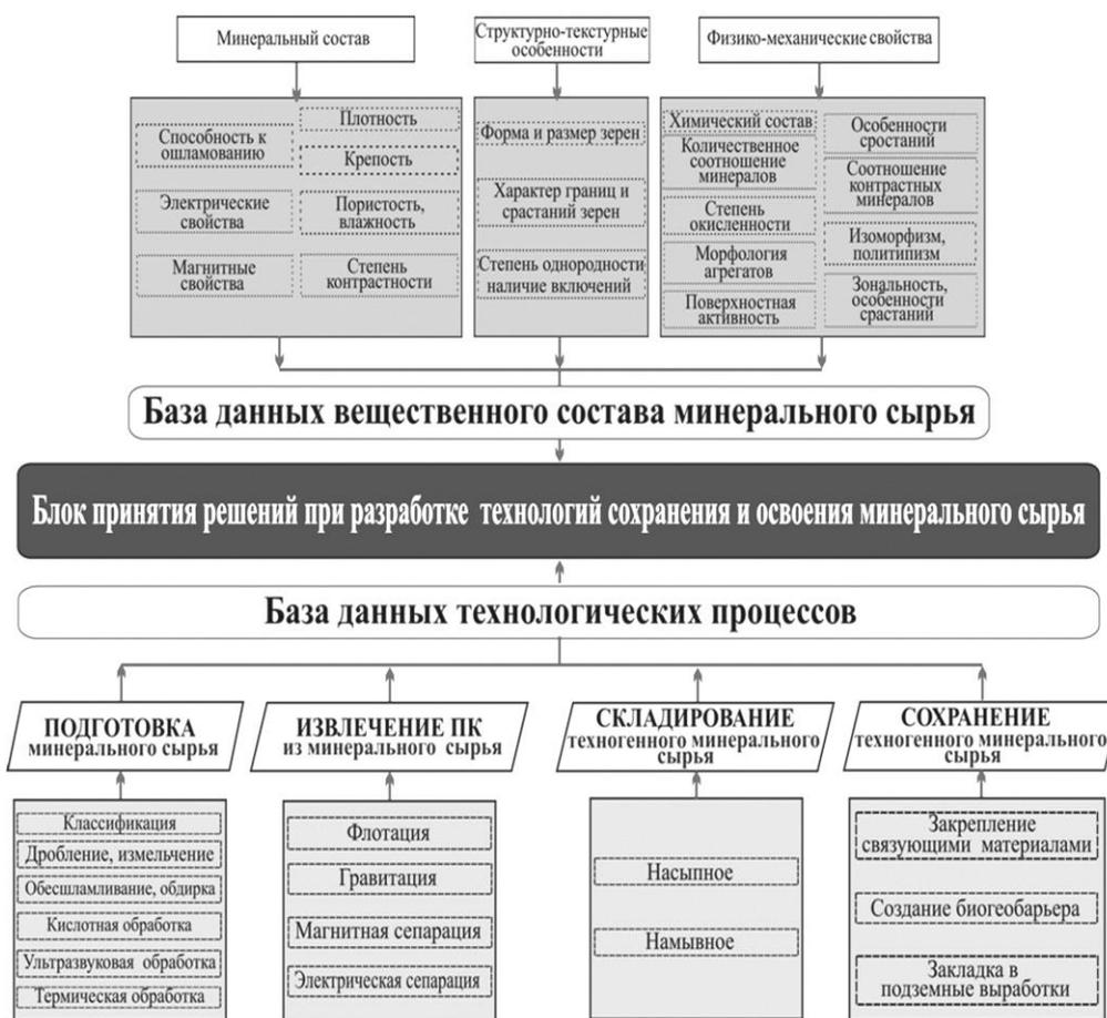
Рис. 1. Концептуальная модель информационной системы поддержки принятия решений при разработке технологий сохранения и переработки рудного и техногенного минерального сырья
