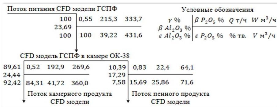
Рис. 2. Базовые параметры CFD модели ГСПФ в первой камере технологической цепочки нефелиновой флотации
