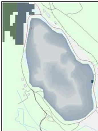
Рис. 5. Зона возможного затопления при аварии на дамбе №1 в створе 1-1
