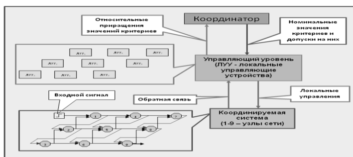
Рис.7. Упрощенная схема децентрализованной системы управления сетью объектов
