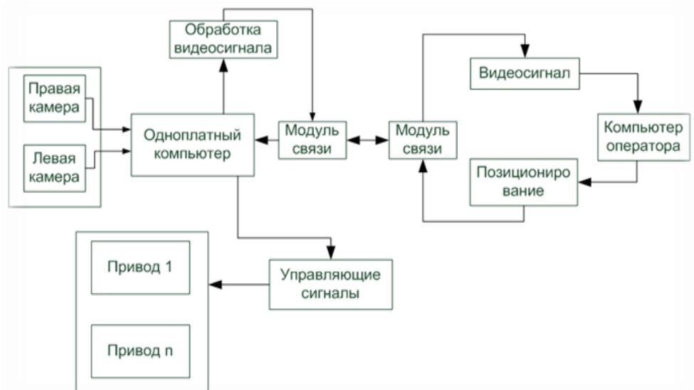
Рис. 1. Архитектура программно-аппаратного комплекса
