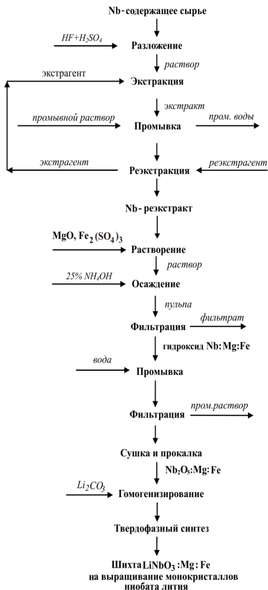
Рис. 1. Технологическая схема получения шихты LiNbO 3 :Mg:Fe
