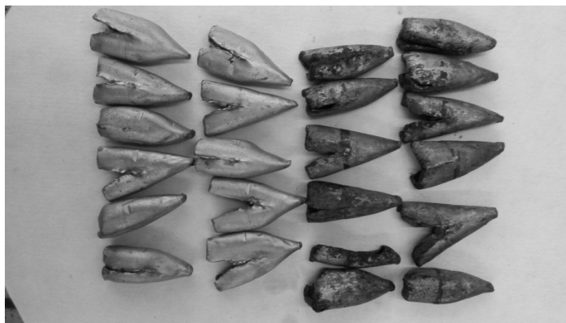
Рисунок 1. Вид деталей после снятия покрытия сульфатным (слева) и хлоридным (справа) травильным раствором.
