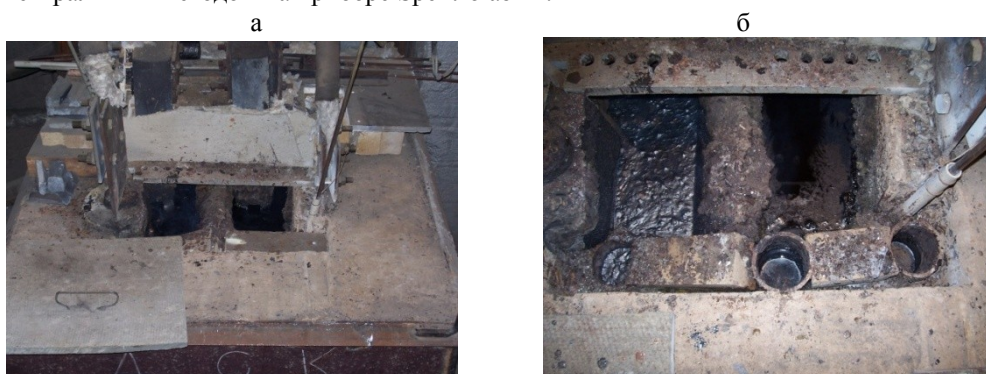
Рис.2. Внешний вид электролизера в рабочем состоянии при 803 К: а – вид спереди; б – вид сверху
