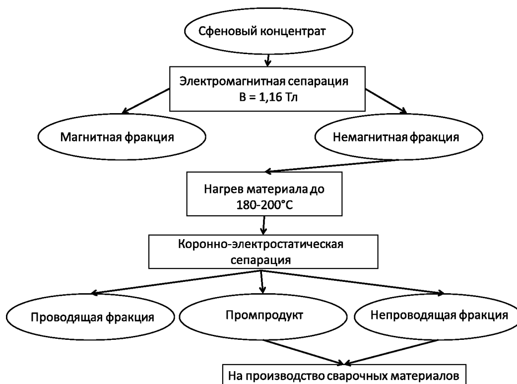
Рис. 1. Усовершенствованная схема радиационной очистки сфенового концентрата
