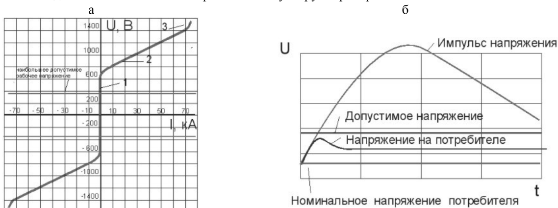
Рис. 1. Вольт-амперная характеристика варистора (а) и «Срезание» импульса напряжения (б)
