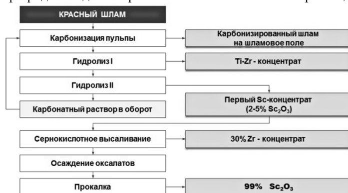
Рис.1. Схема содощелочной технологии переработки красных шламов глиноземного производства
