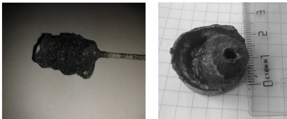
Рис.1. Металло-солевая груша интерметаллидов гольмия и никеля и катодный осадок интерметаллидов гольмия с кобальтом на алундовой подложке
