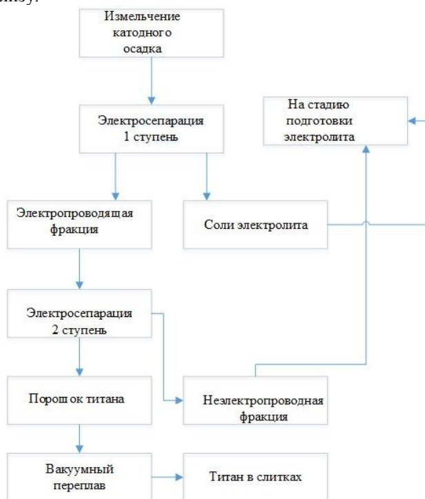
Рис.1. Схема переработки катодного осадка
