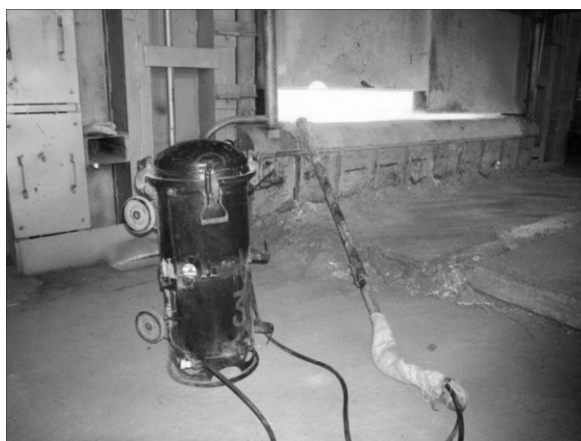
Рис. 1. Промышленная установка «УФР-20» для инъекции технологического порошка в жидкий сплав (ОАО «КУМЗ»)
