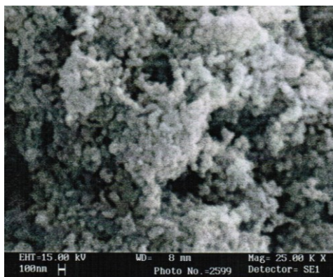
Рис.2. SEM-изображение ZnO, полученного при 500°C и расходе сахарозы 0.55 г
