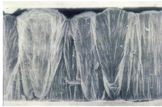
Рис. 7. Конусообразная структура пироуглерода
