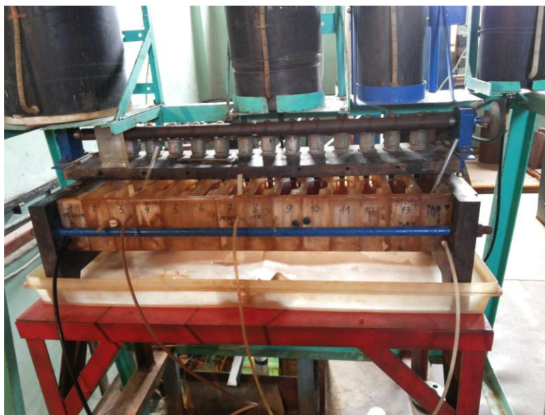
Рис. 3. Смесительно-отстойный 14-ступенчатый экстрактор
