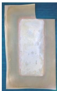
Рис. 2. Катионообменная мембрана МК-40 с налетом осадка \text{Ca}(\text{OH})_2 на поверхности
