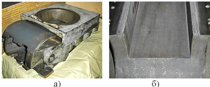
Рис. 5. Пример применения ЭИЛ при агрегатном ремонте: а — делительная головка тестоделителя; б — основание всасывающей камеры
