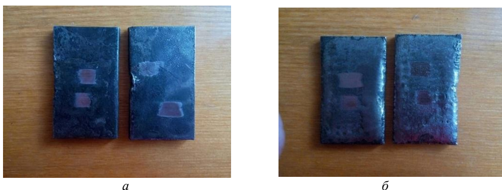
Рис. 2. Изображение образцов стали 65Г после испытаний на износ: a — образцы без покрытия, контрольные; b — образцы с ТВЧ-борированием
