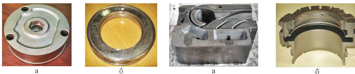
Рис. 2. Примеры упрочняемых инструментов для обработки давлением:
