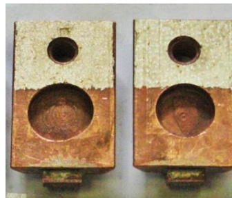
Рис. 6. Пример применения ЭИЛ для серебрения электрических контактов
