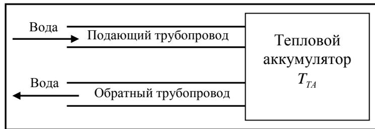
Рис.1. Схема движения теплоносителя водяного теплового аккумулятора
