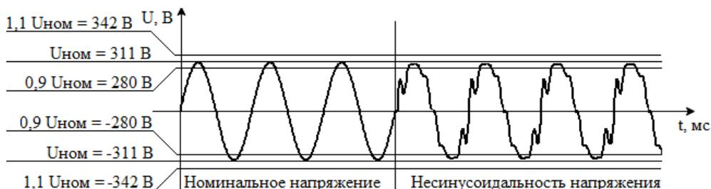
Рис.3. Несинусоидальность напряжения для сети 0.4 кВ
