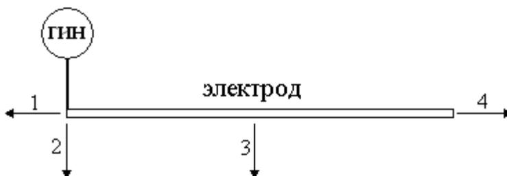
Рис.2. Схема измерения потенциалов вокруг протяженного электрода
