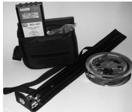
Рис.12. Общий вид измерителя импульсных сопротивлений WG-407 (16)
