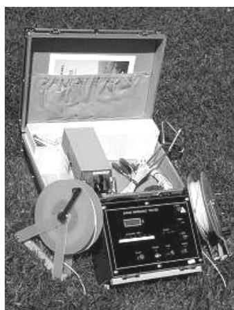
Рис.5. Общий вид тестера импульсных импедансов PET-7 ( http://www.sankosha-usa.com/graphics/surge-1.jpg )
