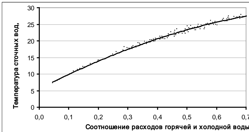
Рис.10. Зависимость температуры сточных вод жилого дома от соотношения расходов горячей и холодной воды v_{\text{г.г}} / v_{\text{х.х}}
