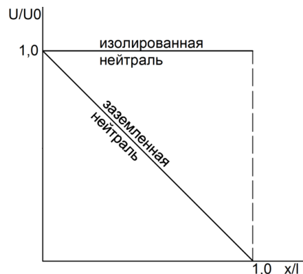
Рис.2. Распределение напряжения вдоль обмотки в установившемся режиме
