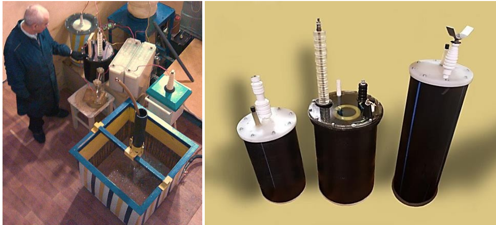
Рис.4. Лабораторный стенд макета буровой ЭИ установки ЦФТПЭС КНЦ РАН для проведения исследований энергетической оптимизации процесса генерирования высоковольтных импульсов
