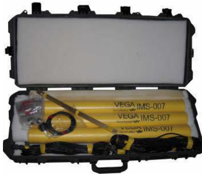
Рис. 8. Индукционные датчики IMS-007 (3 шт), входящие в комплект станции VMTU-10. Датчики находятся в транспортировочном боксе
