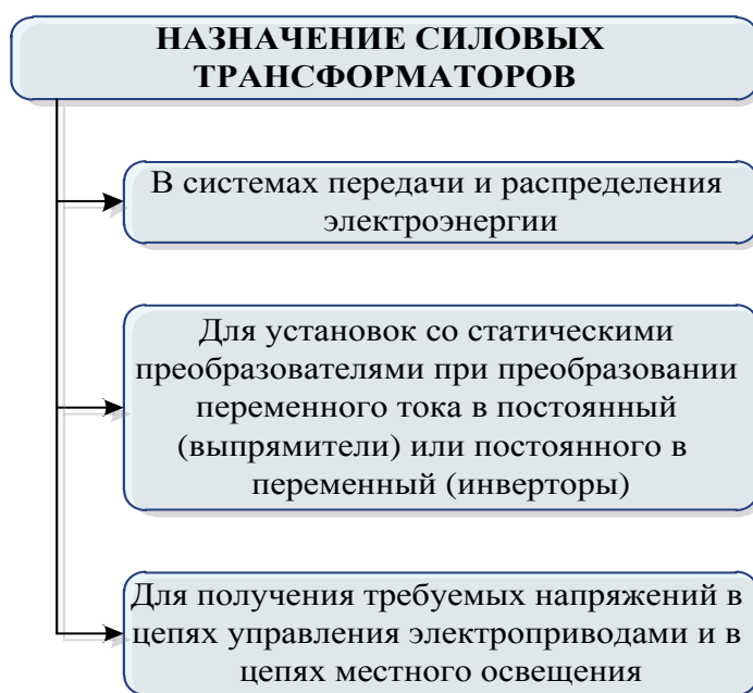
Рис. 2. Классификация силовых трансформаторов по назначению
