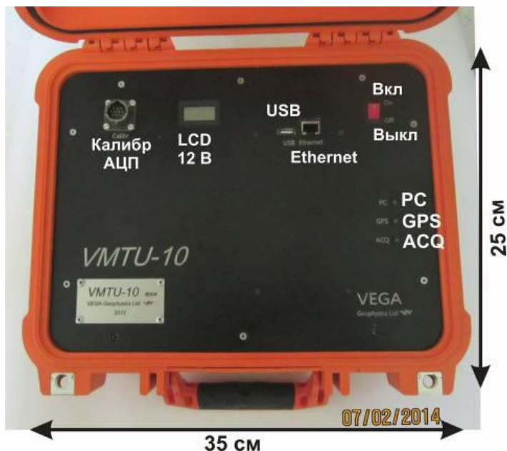
Рис. 6. Измерительный блок станции VMTU-10 (вид сверху): калибр АЦП – разъем для калибровки каналов и для вывода на внешний АЦП; LCD 12 В – ЖК дисплей контроля питания; USB – гнездо питания WiFi адаптера; Ethernet – гнездо для считывания информации либо по кабелю PC либо через Wi-Fi адаптер; Вкл-Выкл – тумблер включения-выключения; PC, GPS, ACS – индикаторы видов работы
