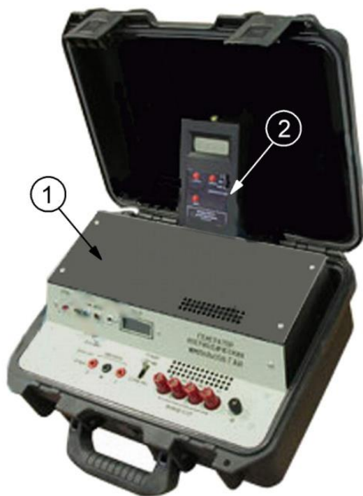
Рис. 4. Измерительный комплекс ИК-1 для определения импульсного сопротивления контуров заземления:
