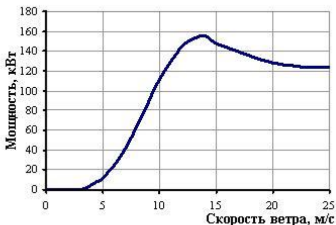
Рис. 3. Рабочая характеристика ветроустановки Vonus мощностью 150 кВт
