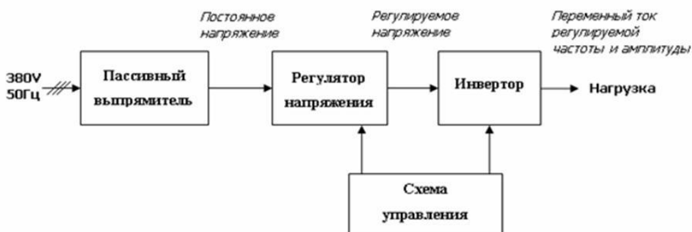
Рис. 3. Структурная схема генератора «Энергия-1».
